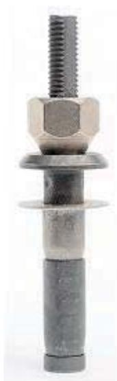
La capacité du RADIAL-LOK® à s'étendre uniformément (de 0.002" à 0.006") dans toute la longueur du trou augmente considérablement la résistance à la fatigue et assure l'intégrité structurale dans des conditions de charges importantes sur des structures en aluminium ou en composites.
