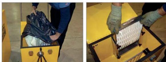
Cette conception unique permet aux utilisateurs de changer les filtres en toute sécurité. En laissant le fonctionnement de vide pendant le changement du sac filtre, le flux va vers le préfiltre et protège l'opérateur d'une exposition aux poussières. En laissant le fonctionnement de vide pendant le changement du pré-filtre, le flux passe par le filtre ULPA qui capture toutes les poussières qui voudraient s'échapper.
